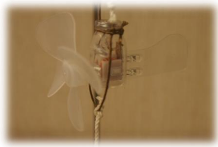
圖：扇葉、發電機與發光之 LED 整合成之小型風力發電機
